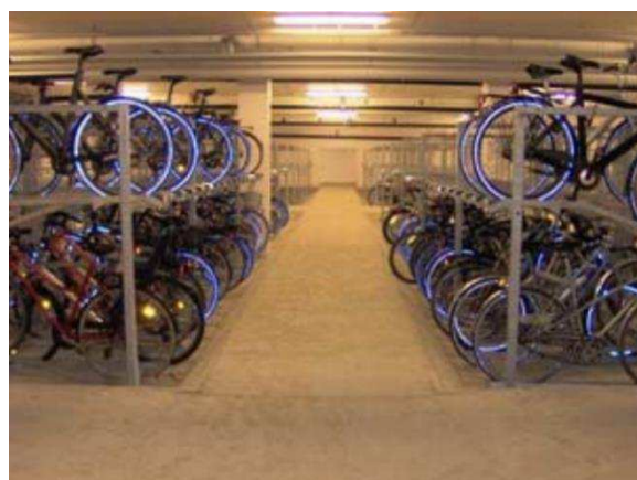
Illustration och foto på tvåvåningsställ som planeras att nyttjas i Skalhols garage. C-c måttet är 428 mm. Illustrationen visar en ställ för 14 cyklar som har längden 3120 mm.
