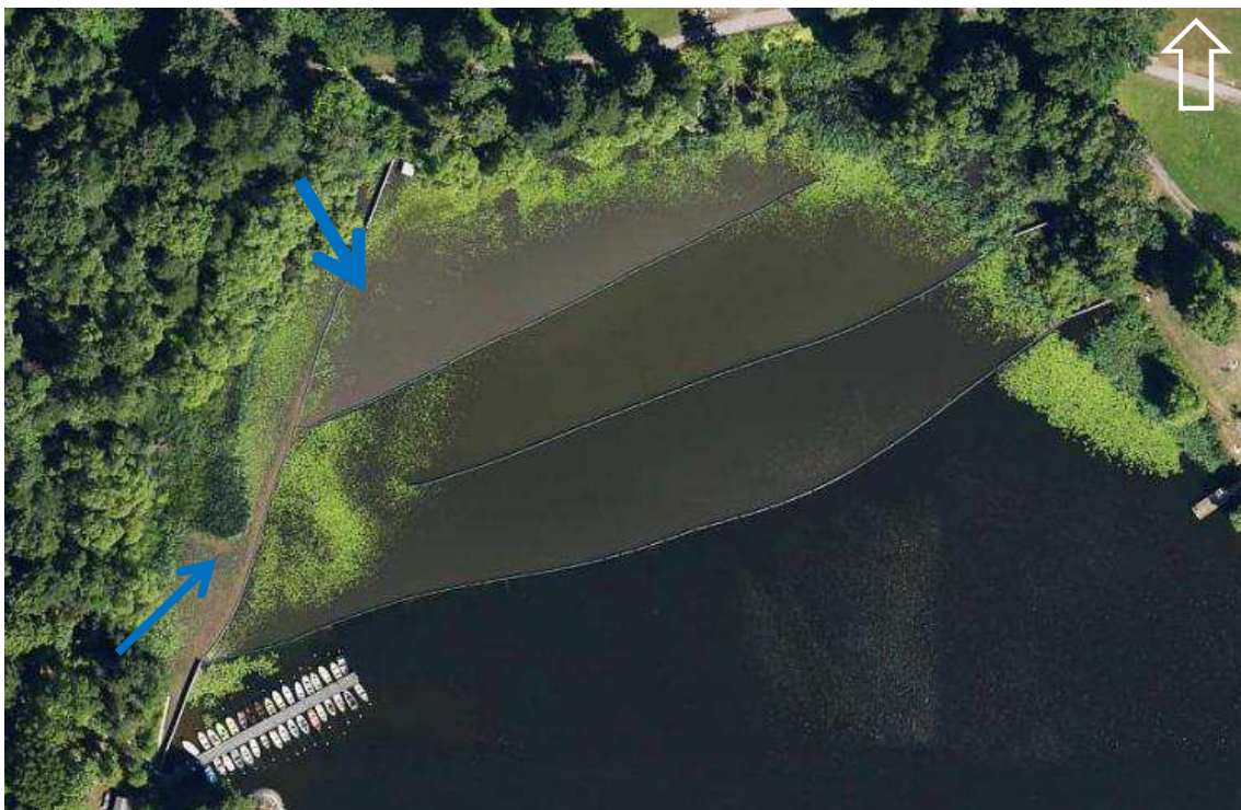
Figur 4. Flygfoto som visar att reningsanläggningen i Drevviken har förmåga att avskilja partiklar i inkommande dagvatten.
