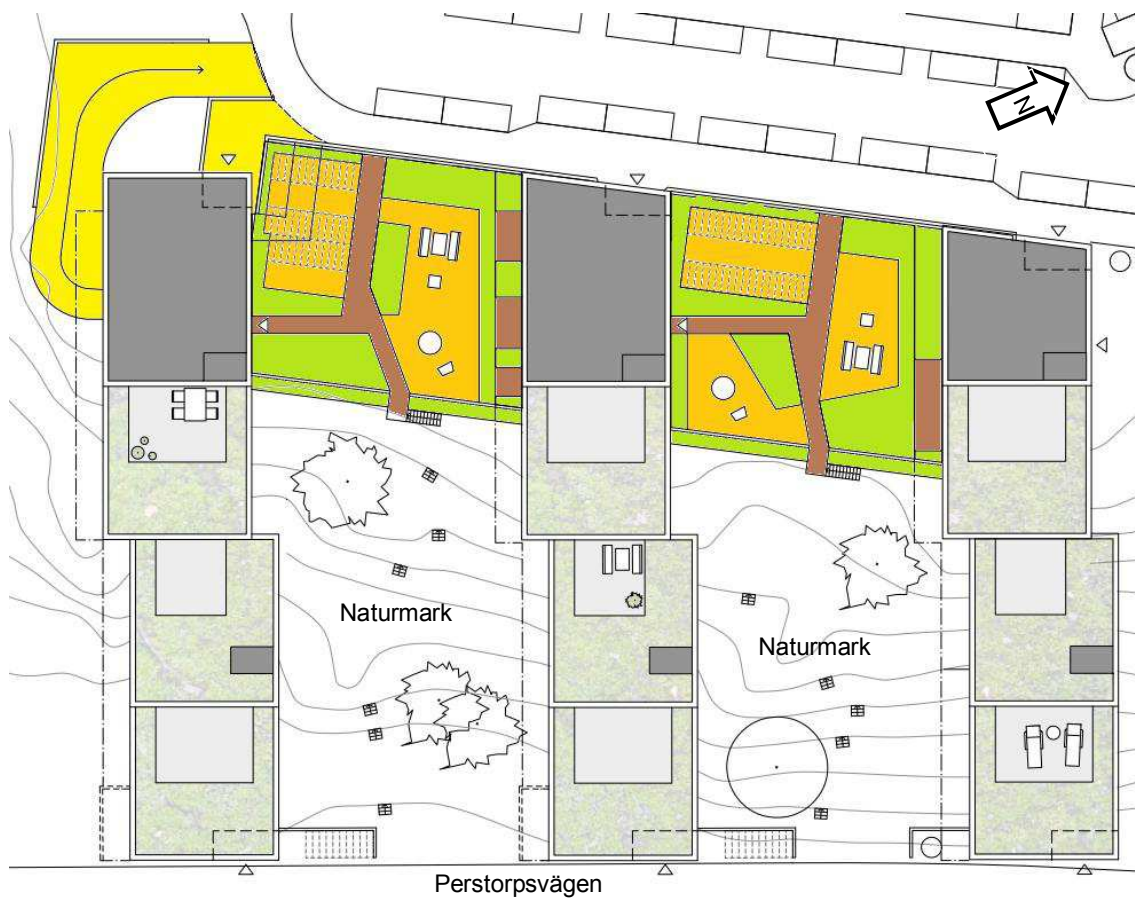
Illustration av ytuppskattning efter omdaning för östra delen mot Perstorpsvägen (Victor Hanson). Grå ytor visar tak (ej gröna tak), brun färg gångar, orange ytor visar grus. Färglagd del utöver gröna tak är underbyggd mark.
