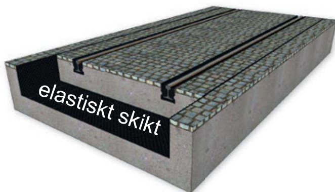
Figur 6. Principskiss för vibrationsreducerande matta under spårkroppen. Denna lösning är aktuell i gatumiljö. Spåren kan då sänkas ner i betongfundamentet. Bild: RubberGreen Industrie SA.
