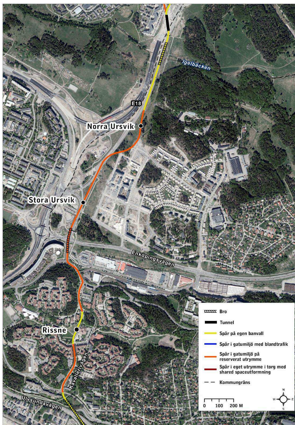
Figur 4 - Passage Ulvsundavägen - passage E18. För närvarande utreds om Kistagrenen ska passera Enköpingsvägen på bro eller i en plankorsning.
