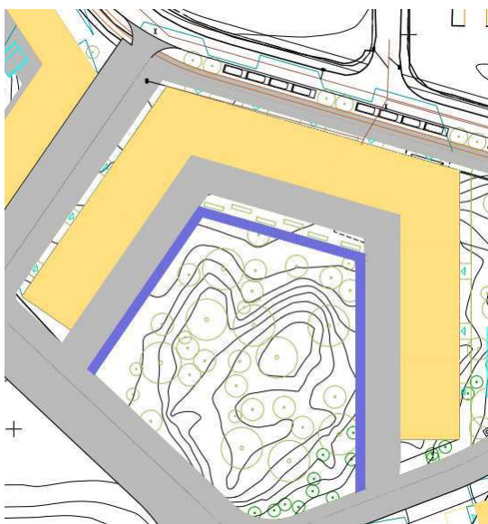
Figur 6: Illustration som visar dike längs med naturyta vid U-hus.
