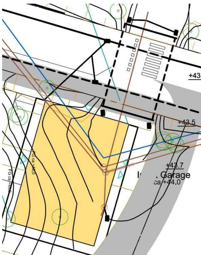
Figur 3: Befintliga dagvatten-, spillvatten- och vattenledningar under planerat punkthus.
