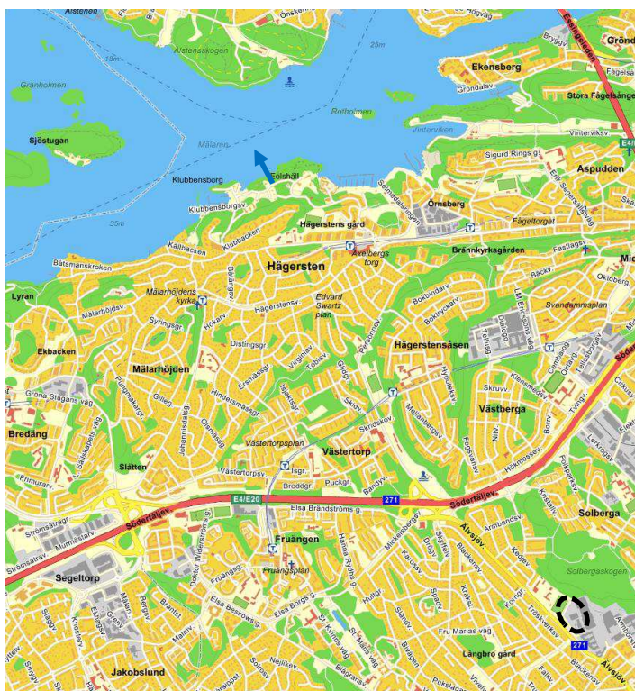
Figur 3. Utsläppspunkt under vinterperioden i Mälaren från Älvsjö-Mälaren tunneln. Sommartid leds dagvattnet till SYVAB:s reningsverk vid Himmerfjärden. Planområdet markerat.
