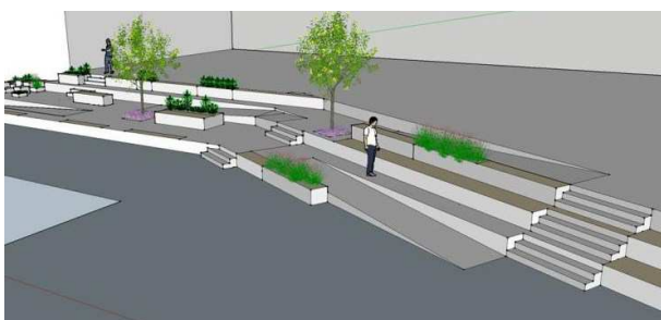
Idéskiss över uppbyggd sitt- och lekstruktur på gården, placerad i soligt läge i fastighetsgräns mot Blåstern 6. Konstruktionen tar upp nivåskillnaden mellan de bägge fastigheterna. Ramper sluttar max 1:12. Planteringar integreras i volymen.
