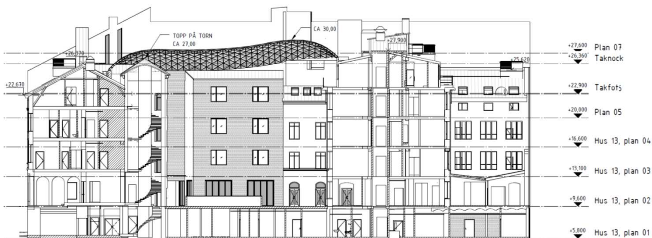
Sektion genom planområdet med Nybrogatan till vänster. Sektionen redovisar höjder av den befintliga och den tillkommande bebyggelsen (grå byggnad) samt höjder på glastaken inom både den större och den mindre gården. Blid: Tengbom.
