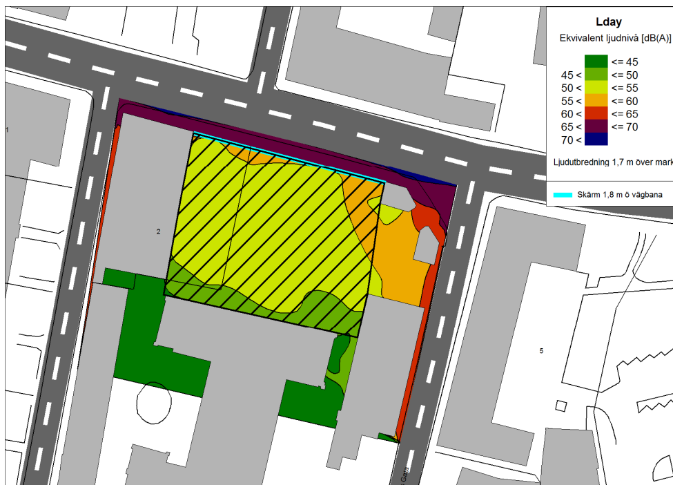
Figur 5.4-4 Bullerutbredning med en 1,8 m hög skärm längs Hantverkargatan. Skärmlängd ca 44 m.
