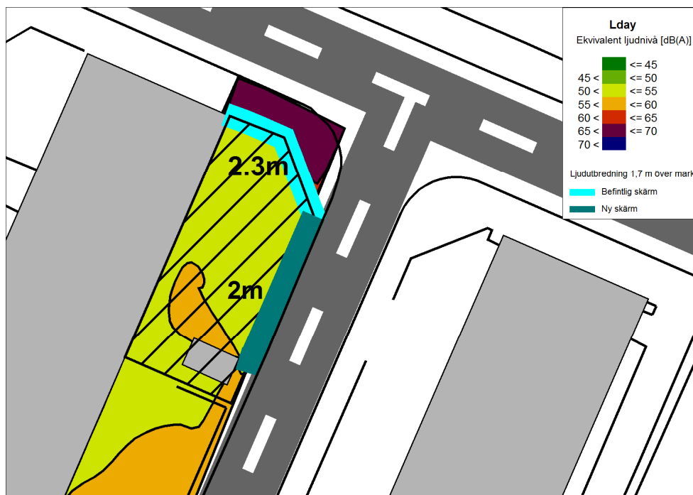
Figur 5.6-4 Bullerutbredning med en förlängd skärm med skärmhöjden 2 m och längden ca 15 m längs Rigagatan och en ökning av höjden på befintlig skärm till 2,3 m längs Valhallavägen.
