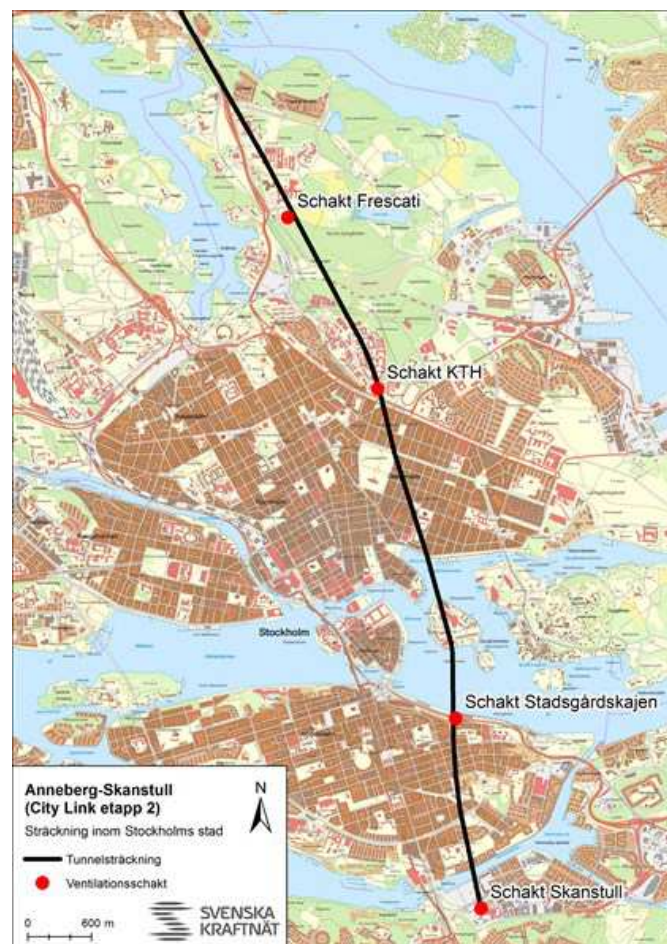
Planerade ventilationsschakt längs tunnelsträckningen.
