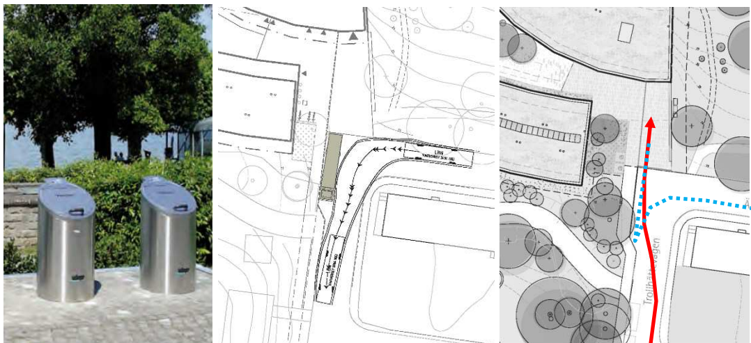
Bild vänster: Referensbild på moloker. Bild mitten: Inlastning med förbipasserande lastbil. Bild höger: Tömning av moloker. Röd pil visar fordon som åker framåt och Blå pil visar hur fordon backar ut och åker iväg efter tömning.
