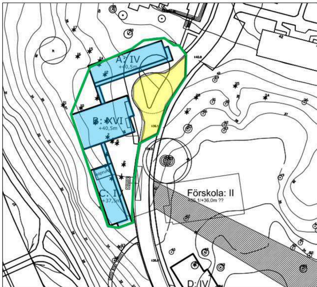
Illustration av ytuppskattning efter omdaning för västra delen mot Nynäsvägen. Blå ytor visar tak, gul yta den nya vägutbredningen och grön linje visar avgränsning.
