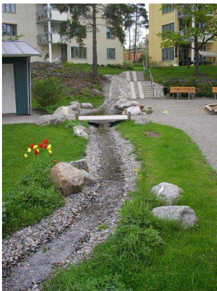
Figur 7. Exempel på ytlig avrinning/infiltrationsstråk i bostadsområde i Västerås
