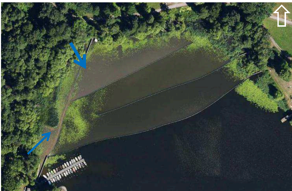
Figur 4. Flygfoto som visar att reningsanläggningen i Drevviken har förmåga att avskilja partiklar i inkommande dagvatten.
