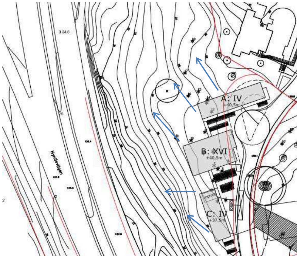
Figur 5. Planerad bebyggelse i den västra delen av området med förslag till LOD på allmän platsmark (bearbetad skiss från White Arkitekter, 20150624). Dagvatten från tak och hårdgjorda ytor kan ledas ut över naturmark väster och norr om bebyggelsen (blå pilar indikerar riktning). Åtgärder för att förhindra erosion i naturmarken bör övervägas.
