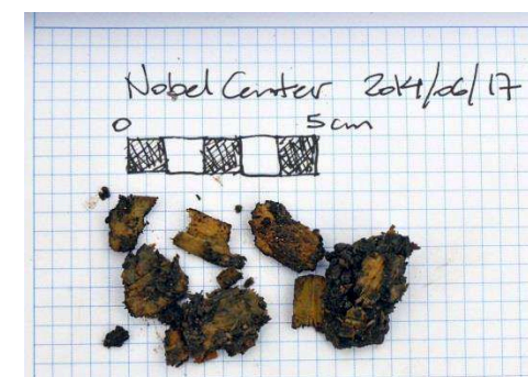
Sammanfattning av resultat från geotekniska undersökningar utförda 2012-2014. Ezequiel Pinto-Guillaume/WSP. Nere till vänster: Större fragment av trä, upp till 90 mm långa (på -4,00 till -4,40 m djup). Nere till höger: Ljusa huggspån av trä från WSP:s geotekniska undersökning under borrhning för grundvattenrör 2014-06-17 (Borrhprov New1) på -2,00 till -2,50 m djup.
