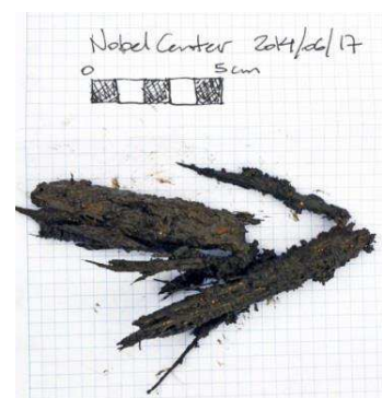
Sammanfattning av resultat från geotekniska undersökningar utförda 2012-2014. Ezequiel Pinto-Guillaume/WSP. Nere till vänster: Större fragment av trä, upp till 90 mm långa (på -4,00 till -4,40 m djup). Nere till höger: Ljusa huggspån av trä från WSP:s geotekniska undersökning under borrhning för grundvattenrör 2014-06-17 (Borrhprov New1) på -2,00 till -2,50 m djup.
