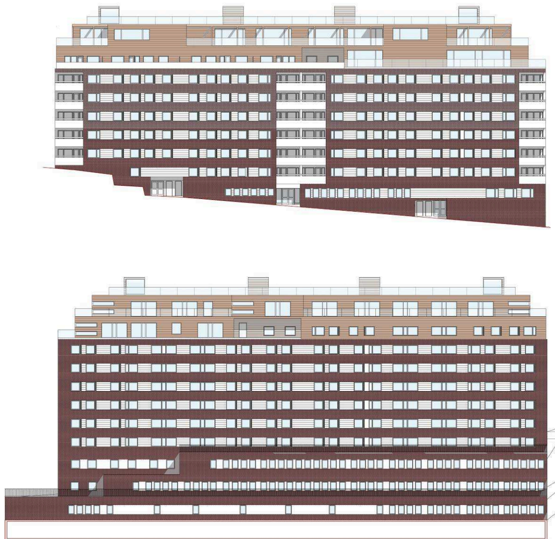
Fasad mot Tulegatan och mot gården. Den befintliga bostadsdelen på plan 11 föreslås få en ny fasad som stämmer överens med den tillkommande påbyggnaden. Illustrationen visar även de föreslagna uterummen på taket. (Selander Ax Arkitekter AB)
