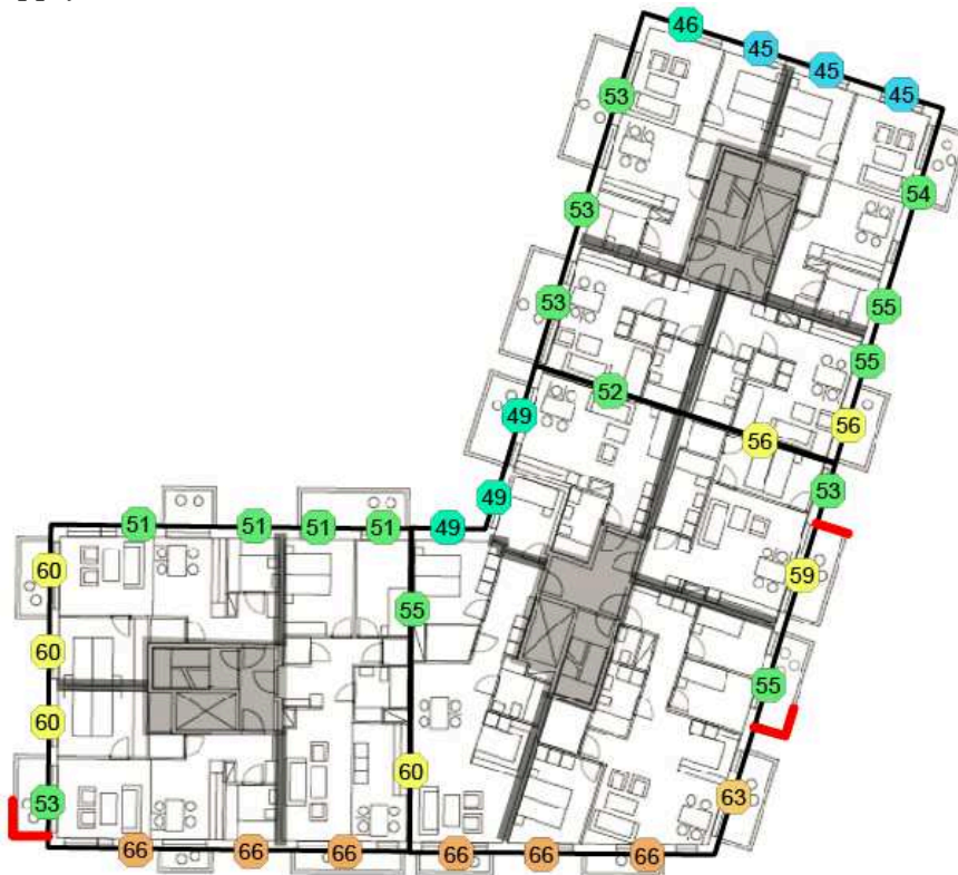
Principskiss för bullerdämpande åtgärd för de bostäder som inte är genomgående. En glasskärm (röd linje) föreslås på balkonger för att skapa en tyst sida för minst hälften av boningsrummen. Bilden visar högsta bullernivåer för alla våningar i husen.
