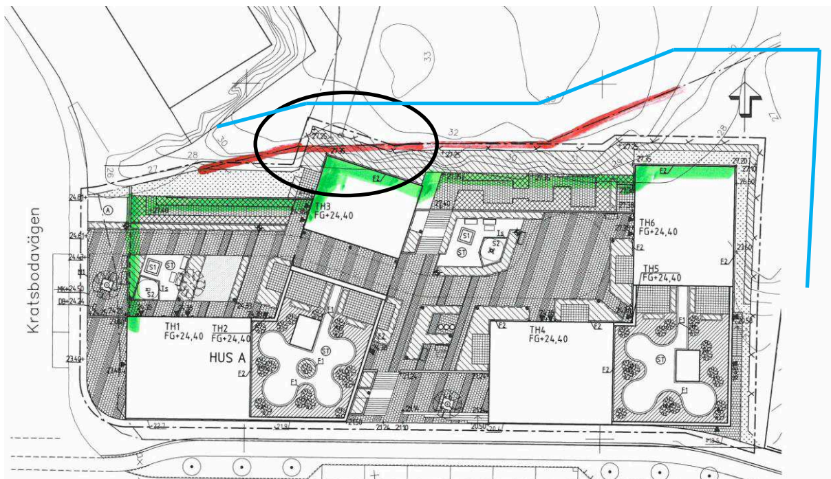
Figur 3: Diskussion har uppstod hur "tårtbiten" ska hanteras. Den blåa linjen markerar intrång i grannfastigheten under byggtiden, ca 5-10 m från krönet.
