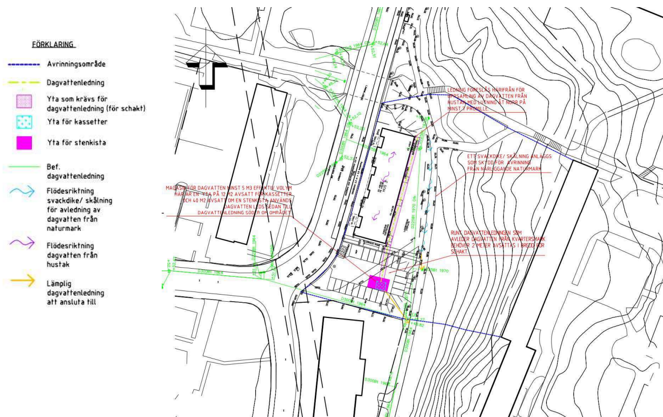
Figur 6. Förslag till dagvattenhantering för hus 3. (För större bild se ritning R-51-P-02)
