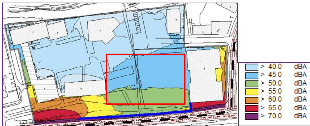
Figur 3. Ekvivalent ljudnivå 2 meter över mark. Bullerskärm längs med fastighetsgräns har illustrerats som ett blått streck precis ovan spårväg/väg.
