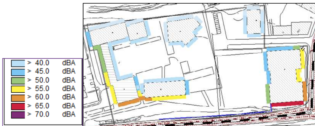
Figur 5. Hösta ekvivalenta ljudnivå vid fasad med bullerskärm längs med fastighetsgräns.
