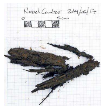
Figur 38. Sammanfattning av resultat från geotekniska undersökningar utförda 2012-2014. Ezequiel Pinto-Guillaume/WSP. Nere till vänster: Större fragment av trä, upp till 90 mm långa (på -4,00 till -4,40 m djup). Nere till höger: Ljusa huggspån av trä från WSPs geotekniska undersökning under borrhning för grundvattenrör 2014-06-17 (Borrprov New1) på -2,00 till -2,50 m djup.
