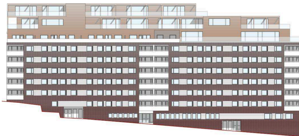
Fasad mot Tulegatan. Den befintliga bostadsdelen på plan 11 föreslås få en ny fasad som stämmer överens med den tillkommande påbyggnaden.
