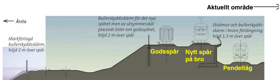
Figur 3.4 Sektion för nytt spår och bro i anslutning till aktuell tomt
