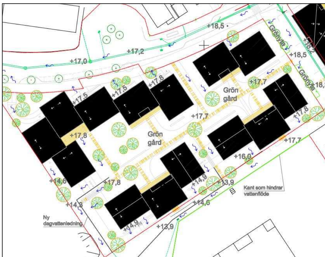
I kvarter Anholt finns ett underliggande garage och innegården är relativt platt. Det är lämpligt att anlägga gården med nedsänkta gräsytor där dagvattenbrunnar placeras i syfte att säkerställa att vatten inte avrinner på ett okontrollerat sätt vid ett extremt regn. Vattnet ansamlas då i grönytorna (jmf bilaga 3). Entré till husen ligger högre än kringliggande mark och risken för skada på fastighet bedöms därför som liten.
