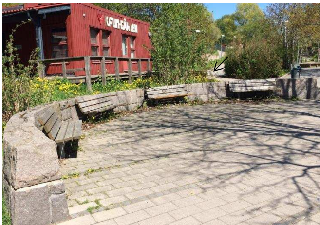
Figur 10 Foto på Kistagången taget från sydvästra hörnet av detaljplanen. Svart pil illustrerar vattnets riktning där Kistagången har brant lutning och där höga vattenhastigheter kan förekomma.
