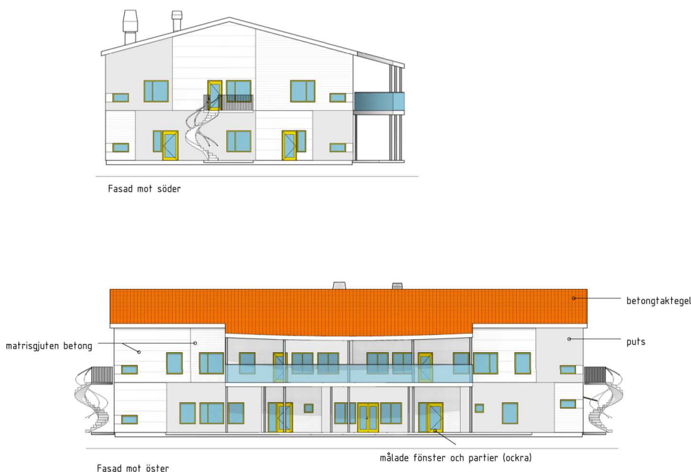
Förslag till fasader. Den övre bilden visar fasad mot söder och den undre fasad mot öster.
