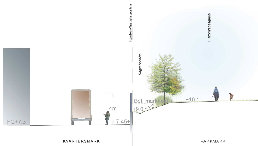
Sektion A-A som visar relation mellan bygghandel, bullerplank med stödmur, marknivåer och ny vegetation (Ramböll)
