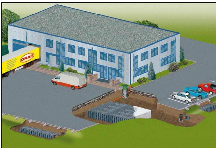
Figur 3. Exempel på utjämningsmagasin bestående av dagvattenkassetter (Illustration: Uponor)
