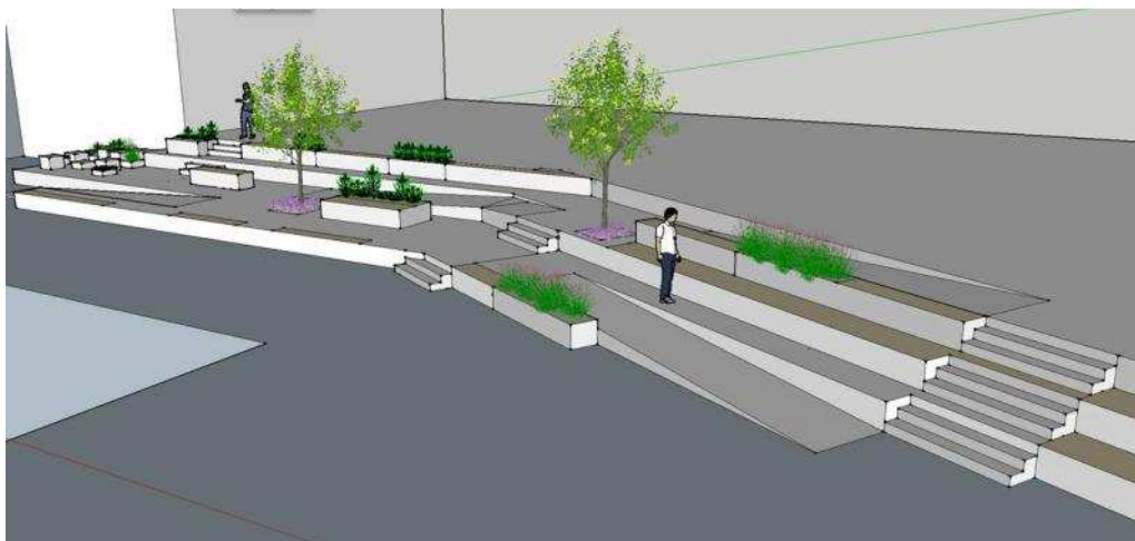
Ny uppbyggd sitt- och lekstruktur på gården, placerad i soligt läge i fastighetsgräns mot Blåstern 6. Konstruktionen tar upp nivåskillnaden mellan de bägge fastigheterna. Ramper sluttar max 1:12. Jordvolymerna för plantering integreras i volymerna.
