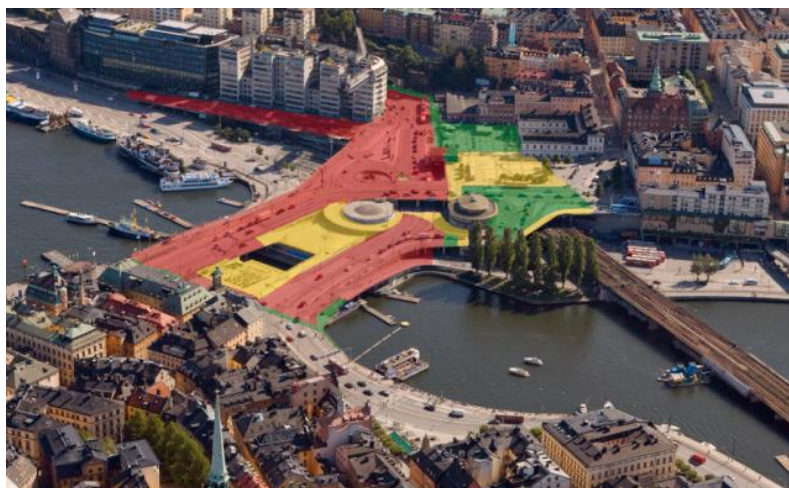
Figur 2. Slussens tekniska skick. De olika färgerna markerar konstruktionens olika livslängd.
