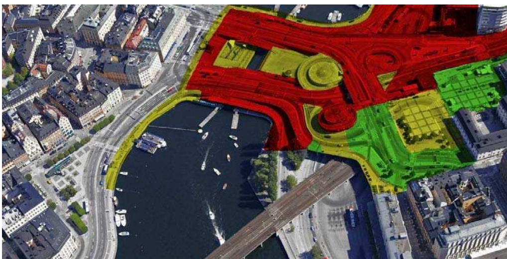
Ortofotot visar hur tillståndet på bärigheten för Slussen ser ut idag. Röd färg markerar konstruktion i mycket dåligt skick, gul färg markerar dåligt skick och grön färg markerar konstruktioner som håller ytterligare några år.
