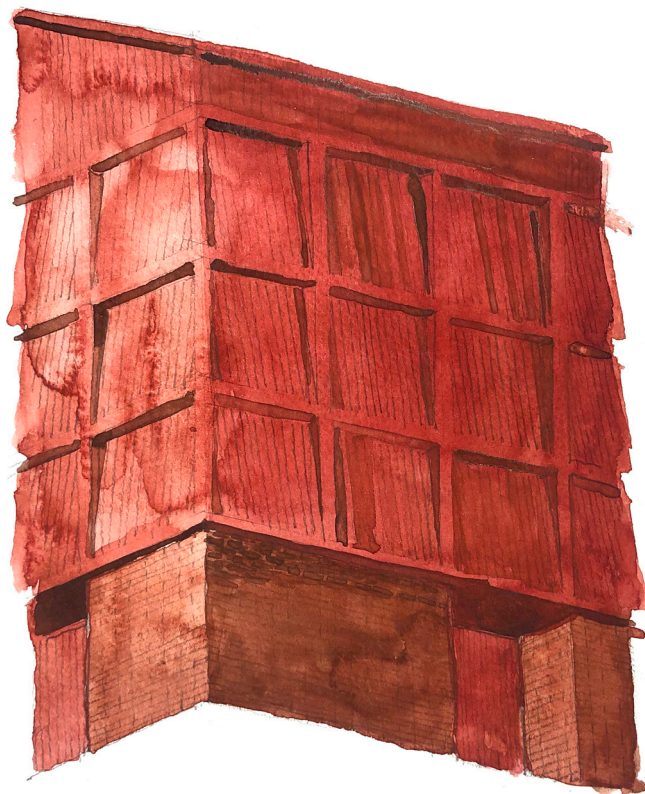
Bild 27. Verkstadshallarnas fasader har under en övervägande del av gestaltungsarbetet präglats av en rutindelning. Att luta panelerna i facken har testats för att utvärdera vad en ökad skuggbildning i fasad kan få för effekt.
