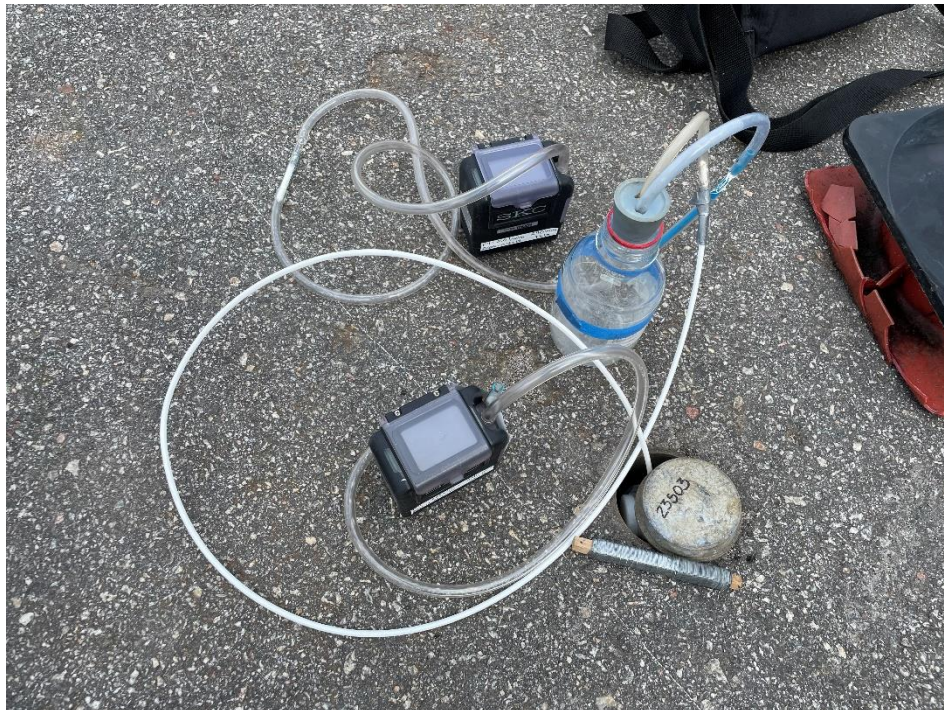
Figur 4. Installation för provtagning av porluft från grundvattenrör 23S03 samt av atmosfärluft.
