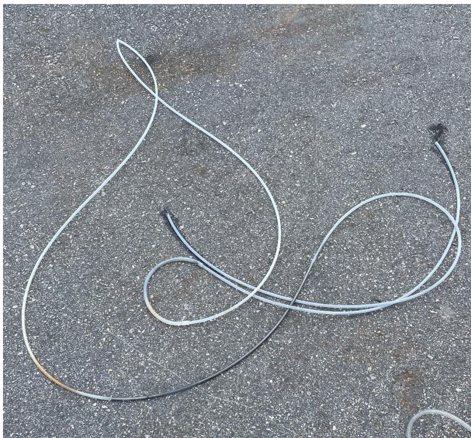
Figur 5. Bild på slang som drogs ur grundvattenrör 23S03 med synligt oljeutslag samt brun missfärgning.
