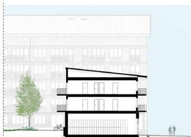
Sektion genom lågdel med cykelrum i bottenvåning och större lägenheter ovanpå.
