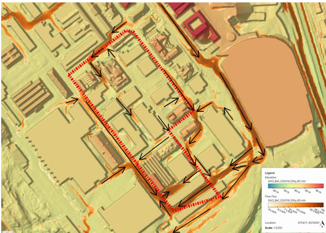
Figur 8 Avrinningsvägar vid befintlig situation inom och i anslutning till detaljplangränsen för Dp 2b. Svarta pilar indikerar generell flödesriktning. Nyanser av orange indikerar olika storlekar på flödet, större flöden vid mörk nyans.
