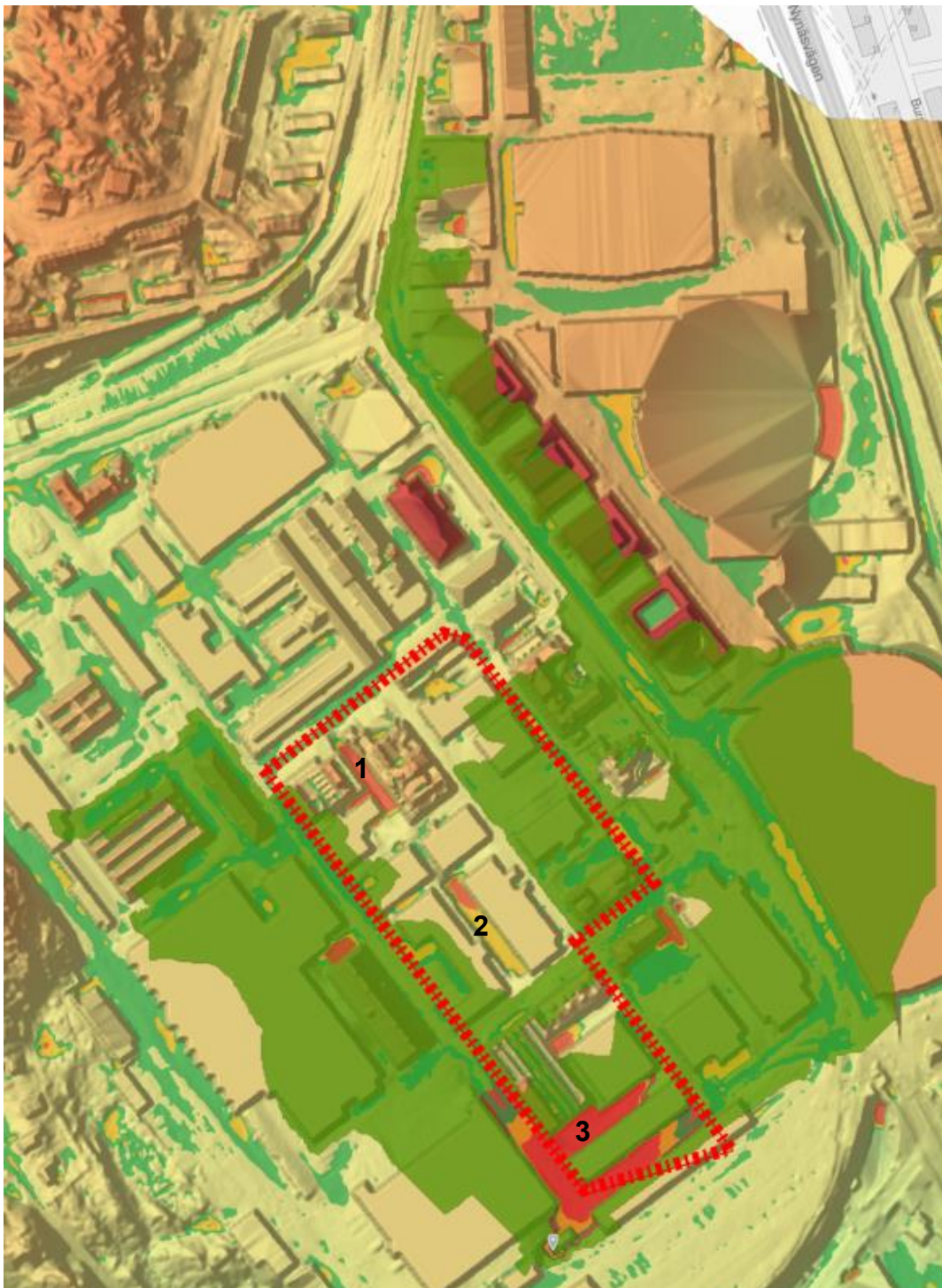
Figur 10 Tillrinningsområde vid undersökt 100-årsregn vid befintlig situation till den södra lågpunkten (3) inom området för det som utgör Dp 2b. Tillrinningsområde i grönt, detaljplanegräns i röstreckat och vattendjup enligt följande; grön = 0,05-0,2 m, gul = 0,2-0,5 m, röd = >0,5 m
