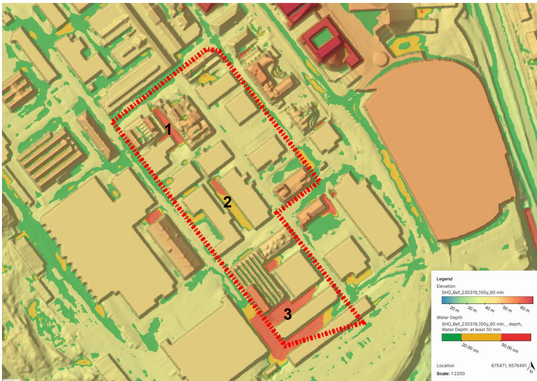
Figur 9 Maxvattendjup vid befintlig situation inom och runt om detaljplanegränsen för Dp 2b. Vattendjup enligt följande; grön = 0,05-0,2 m, gul = 0,2-0,5 m, röd = >0,5 m
