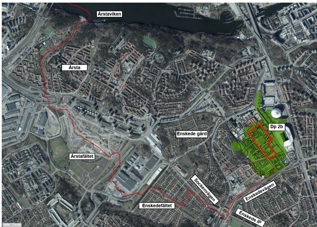
Figur 2 Avrinningsområde Södra Slakthusområdet (grön markering) och dess teoretiska avvattningsriktning mot Årstaviken (svagare röd linje med pilar för flödesriktning). För den teoretiska avrinningsvägen tas ingen hänsyn till lokala lågpunkter längs flödesvägen. Baseras på befintlig situation. Planområdesgräns Dp 2b i röstreckad linje. Källa: SCALGO Live, 2023-01-30
