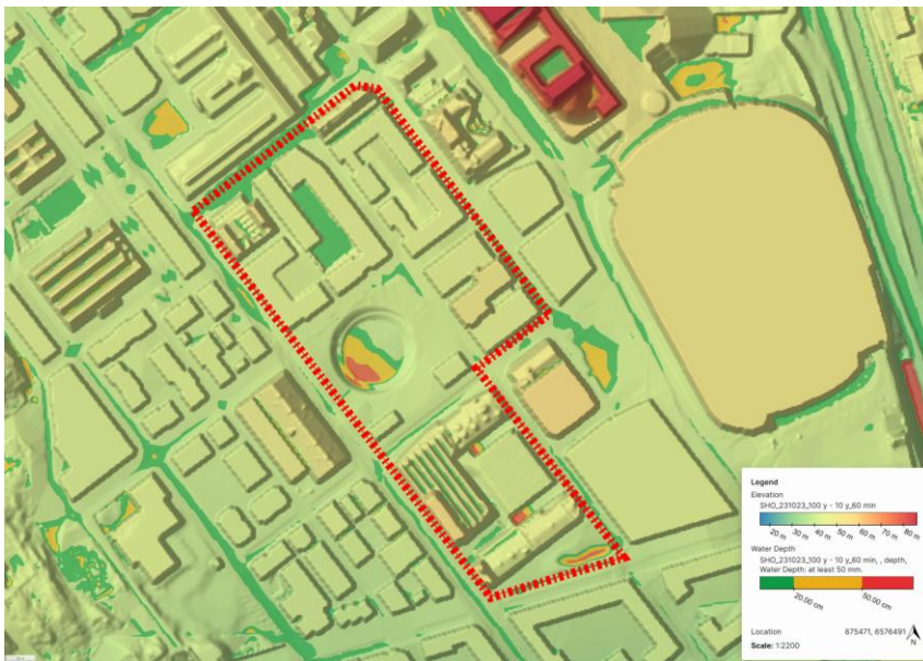
Figur 12 Maxvattendjup vid framtida situation inom och runt om detaljplanegränsen för Dp 2b. Vattendjup enligt följande; grön = 0,05-0,2 m, gul = 0,2-0,5 m, röd = >0,5 m
