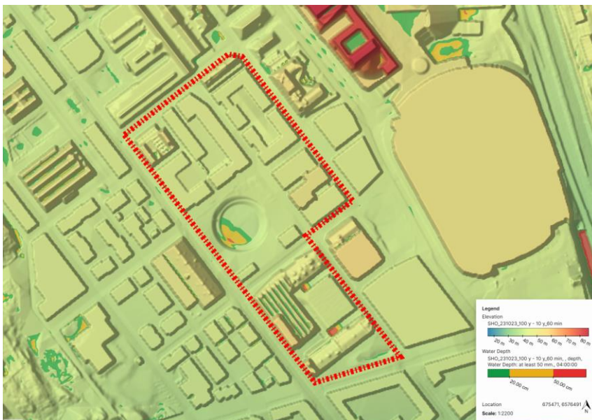
Figur 13 Vattendjup vid framtida situation inom och runt om detaljplanegränsen för Dp 2b vid skyfallssimuleringens slutpunkt. Vattendjup enligt följande; grön = 0,05-0,2 m, gul = 0,2-0,5 m, röd = >0,5 m
