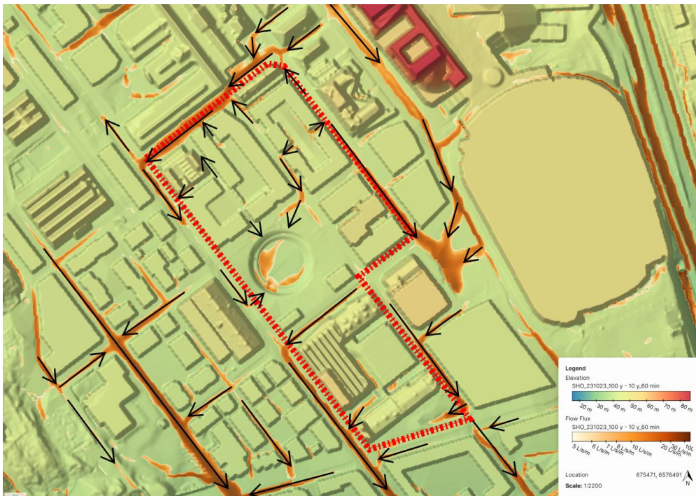
Figur 11 Avrinningsvägar vid framtida situation inom och i anslutning till detaljplanegränsen för Dp 2b. Svarta pilar indikerar generell flödesriktning. Nyanser av orange indikerar olika storlekar på flödet, större flöden vid mörk nyans.
