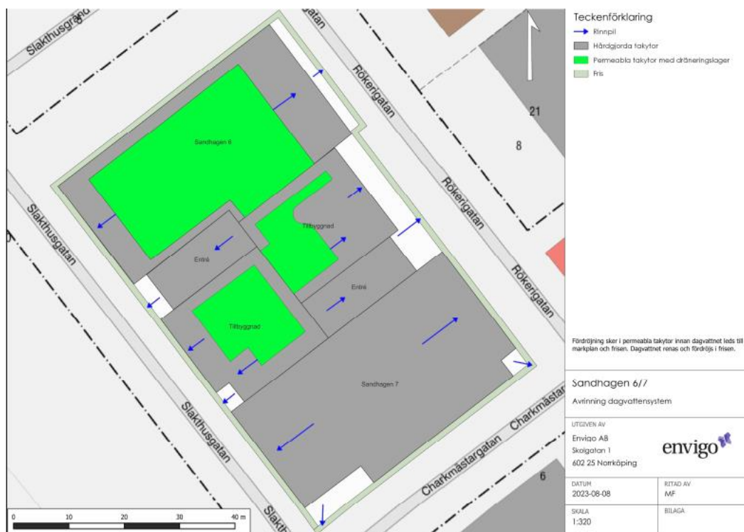
Figur 19. Illustration över dagvattenhanteringen med rinnpilar. För områden med permeabla tak fördröjs och magasineras dagvattnet innan det leds till markplan och vidare till frisen. Dagvattnet från hårdgjorda taktytor leds direkt till markplan och frisen. Dagvatten från hårdgjorda marktytor leds direkt till frisen. Frisen renar, magasinerar och fördröjer dagvatten. Stuprörens placeringar är okända och redovisas därför inte.
