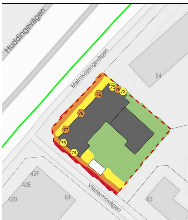
Bild 10 visar att uteplats i söderläge kan placeras på baksidan där den maximala ljudnivån är högst L_{pAFmax} = 70 dBA (grönmarkerat område)
