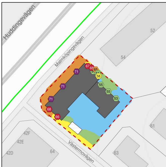
Bild 9 visar att uteplats i söderläge kan placeras på baksidan där den ekvivalenta ljudnivån är högst L_{pAeq} = 50 dBA (blåmarkerat område)
