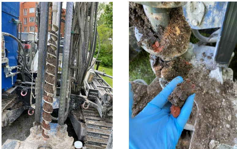
Figur 9. Inslag av tegel etc i fyllnadsmassorna i provpunkt 23AF005 samt 23AF006.
