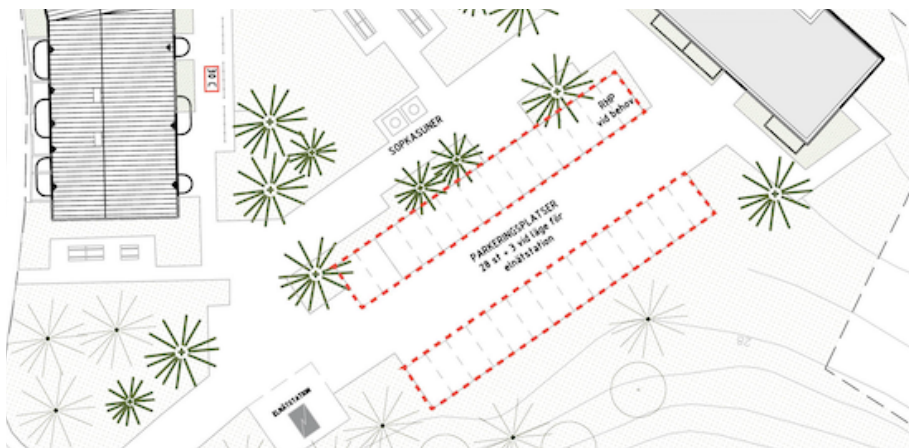
Figur 2: Urklipp från situationsplan hur parkering är tänkt att lösas på gården. Källa: Landskapslaget AB.
