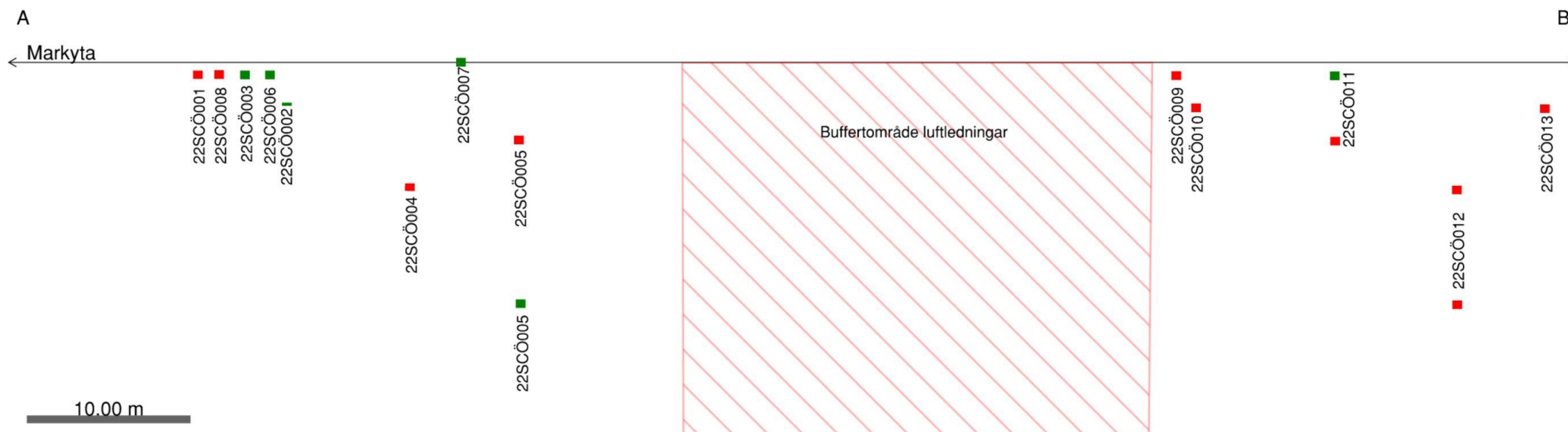
Figur 7-2. Tvärsnitt över undersökningsområdet med provtagningsdjup, mätt från marköverytan. Grön markering indikerar att provpunkten ej anses syraproducerande medan röd markering indikerar risk för syraproducerande berg (Tabell 7-1).
