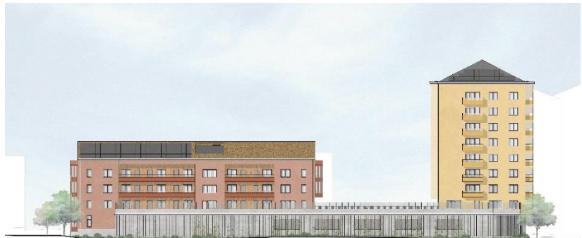
Fasad mot öster och spårområdet. Mot spårområdet placeras garage i sockelvåningen. Sockelvåningen utformas i ett avvikande material samt spaljéer med växtlighet (Reflex arkitekter).
