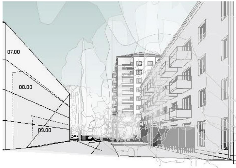
Skuggförhållanden för befintligt lamellhus vid vårdagjämning. Illustrationen visar skuggförhållanden för grannhus vid olika klockslag. Illustration Reflex arkitekter
