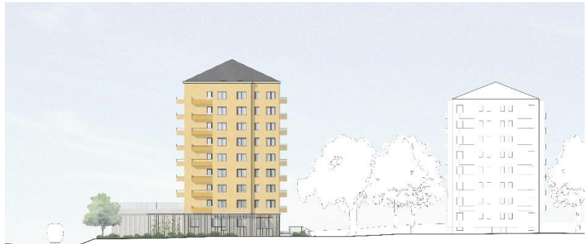
Fasad mot norr och Blåsutparken. Sockelvåningen utformas i ett avvikande material samt spaljéer med växtlighet (Reflex arkitekter).
