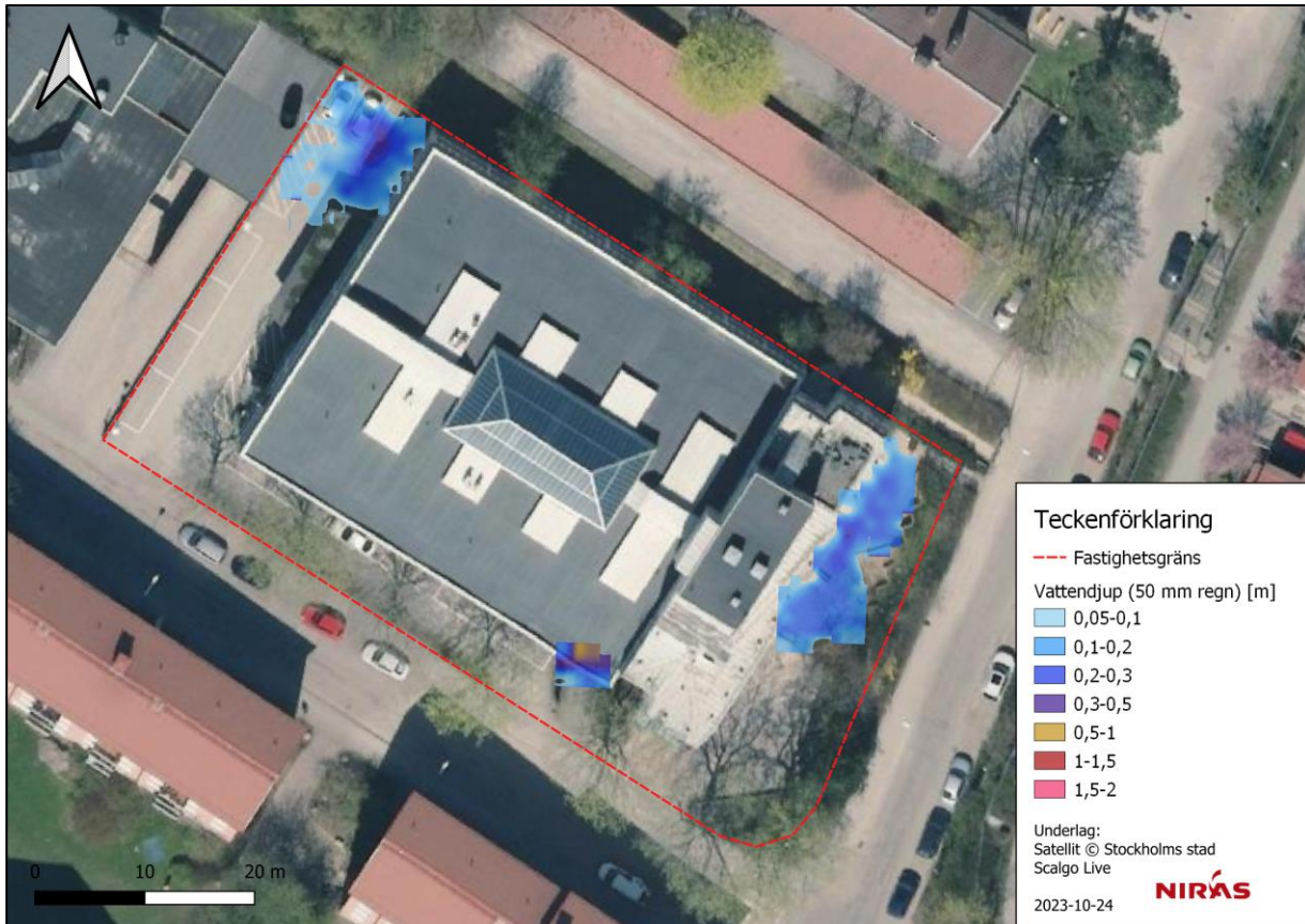
Figur 13. Skyfallsmodellering för fastigheten vid 50 mm regn, modellering utförd i Scalgo Live.
