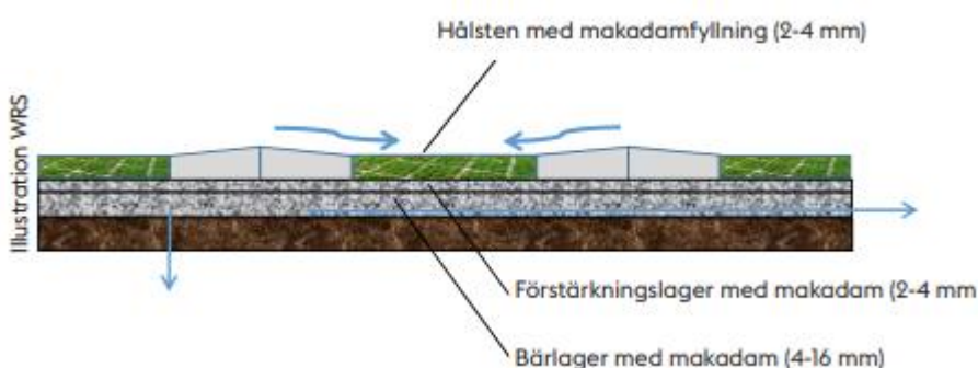
Figur 21. Principskiss för genomsläpplig beläggning (Illustration: WRS).
