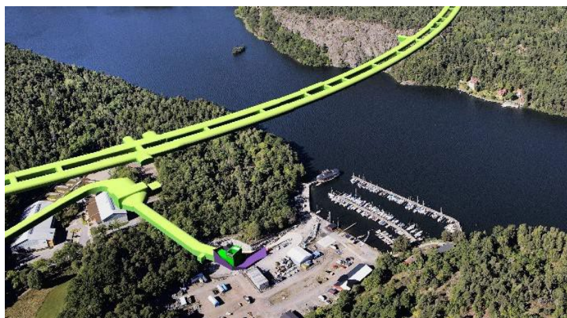
Bild som illustrerar tunnelsystemet för del av Förbifart Stockholm, under marknivå, i ljusgrön färg. Föreslaget brandgasschakt samt betongtunnel illustreras i mörkgrön färg. Bild: Trafikverket
