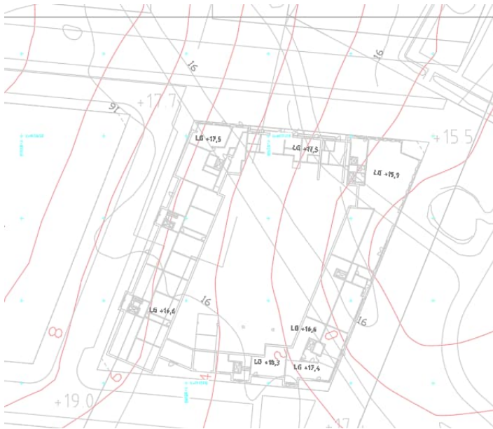
Figur 4. Bedömda jordlagerförhållanden inom kvarter A. Röda linjer visar tolkade bergnivåkurvor.
