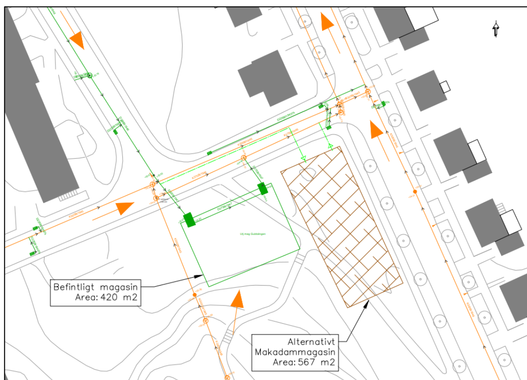
Figur 4. Beräknad erforderlig yta samt föreslagen placering för ett makadammagasin
