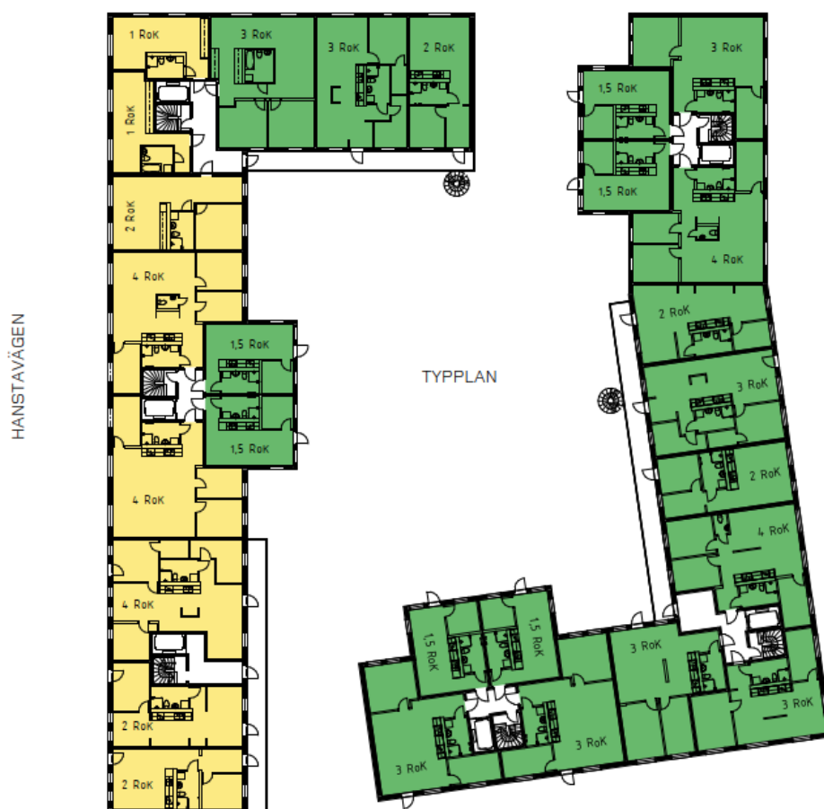
Figur 2 Planlösningar kv C. Gul markering visar vilka lägenheter där den ekvivalent ljudnivån överstiger 60 dBA.
