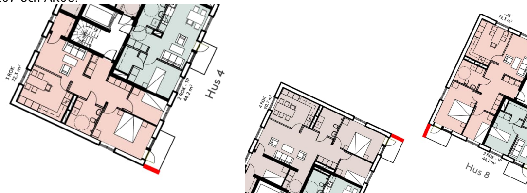
Figur 5. Avskärmningar vid balkong markerat i rött. Södra hörnet t.v. och norra hörnet t.h.
