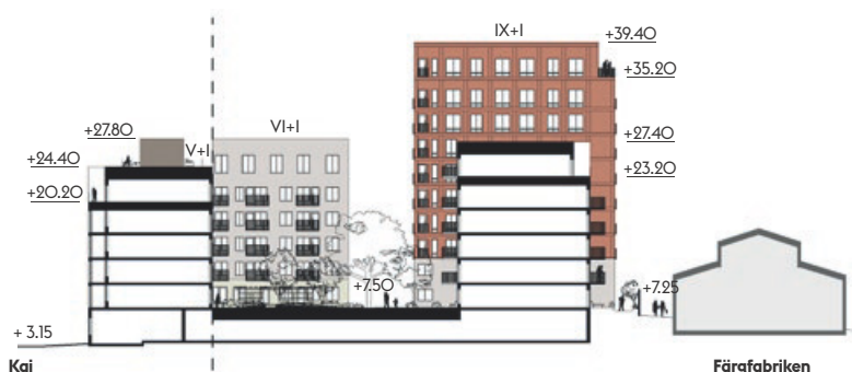
Sektion genom kvarteret – redovisar gaturummet mot färgfabriken samt kvarterets innegård och släpp vid den högre byggnadsvolymen (skala 1:1000).
