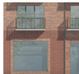
Exempel för sockelvåning kv 1 – reliefmurat tegel och markerade ramar kring fasadöppningar.
