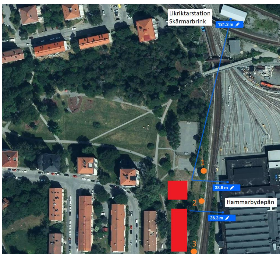
Figur 8. Avstånd till Hammarbydepån där transformatorbås finns (ca. 36 m) samt likriktarstation i Skärmarbrink (ca. 181 m) i förhållande till tänkt bostadsbygge (de röda boxarna).
