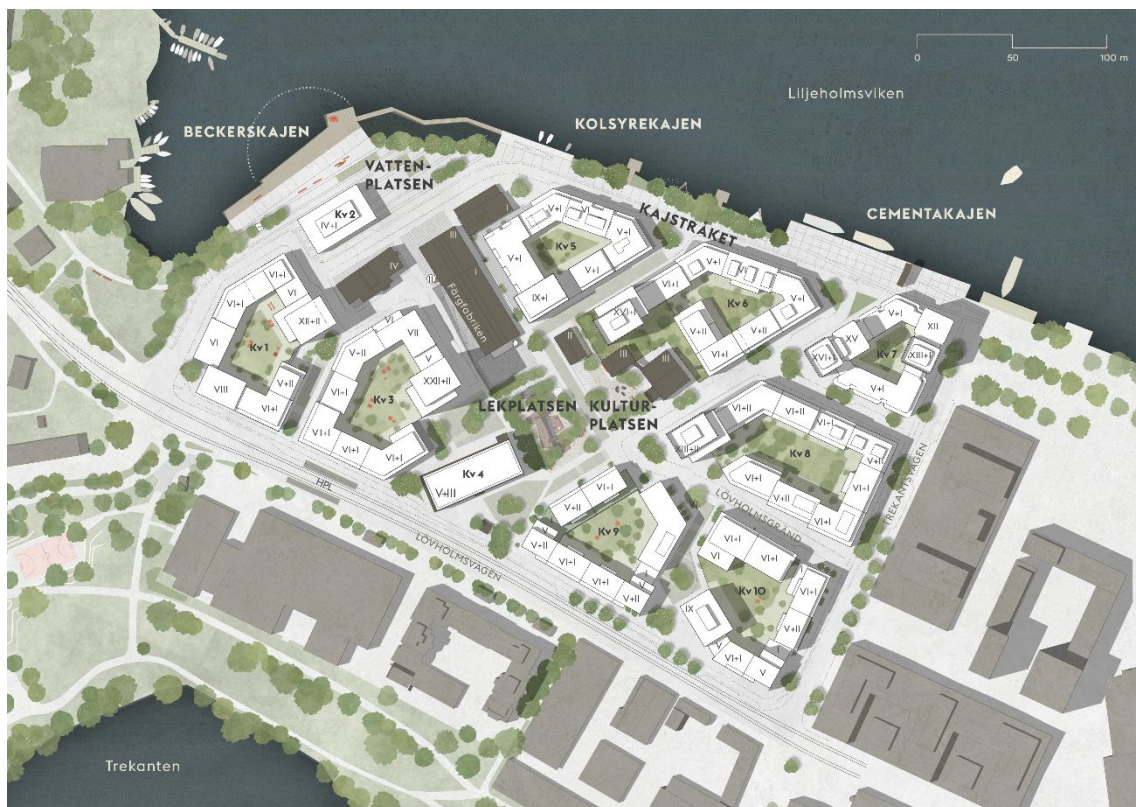
Figur 5.1. Förenklad strukturplan över planområdet. Gråmarkerade byggnader är befintliga som bevaras, vita nya kvarter, påbyggnad föreslås på Beckershuset (Kv 4).
