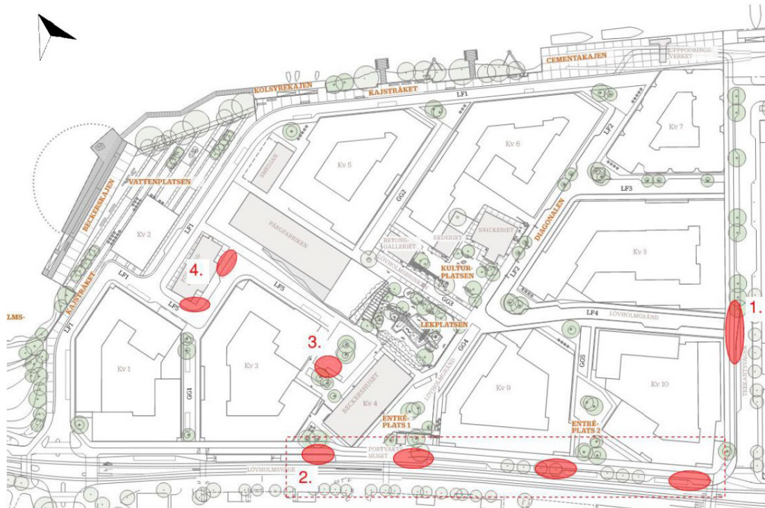
Figur 6.43. Identifierade lågpunkter inom utredningsområdet vid planerad situation. (Structor Mark Uppsala AB, 2023)
