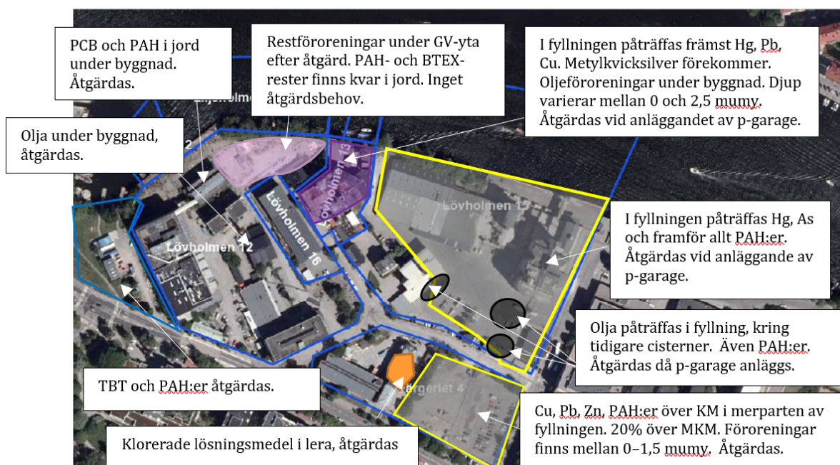
Figur 6.18. Sammanfattande åtgärdsbehov inom Lövholmen. Stor del av åtgärder sker genom schaktning, genom att garage anläggs under samtliga bostadskvarter.
