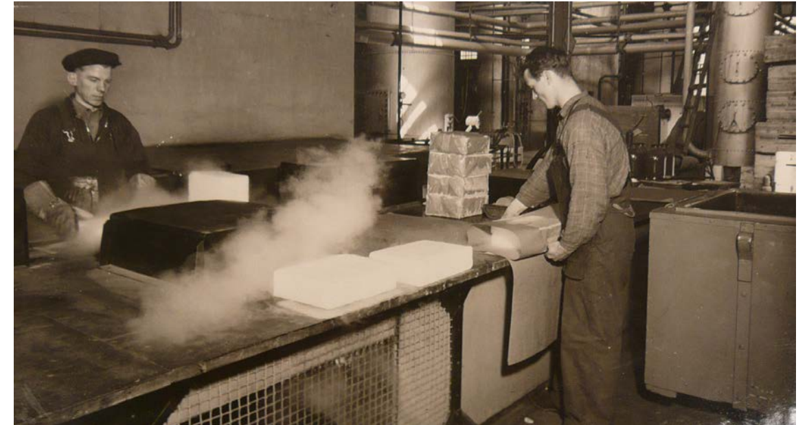
Produktion av torrisblock i Kolsyrefabriken, 1943. Källa: Tekniska museets arkiv
