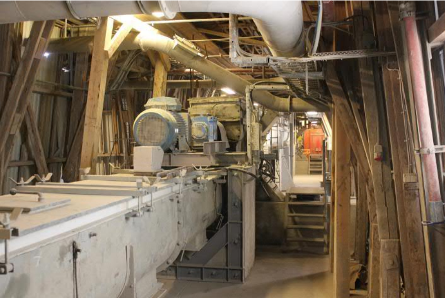
Skruvtransportören längst upp i siloanläggningen.
