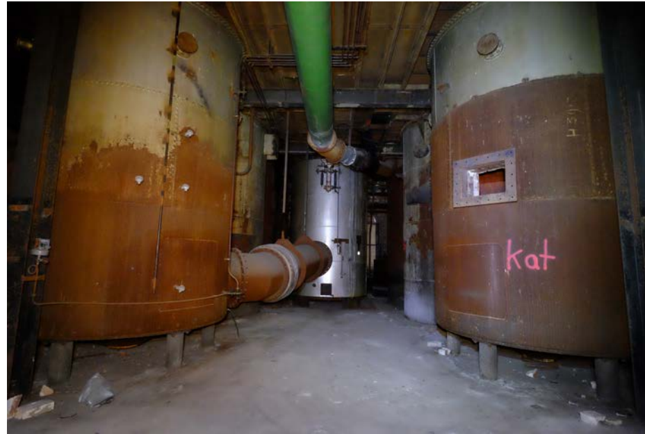
Från vänster: generator, överhettare (halvt dold), ångpanna, överhettare, generator.
